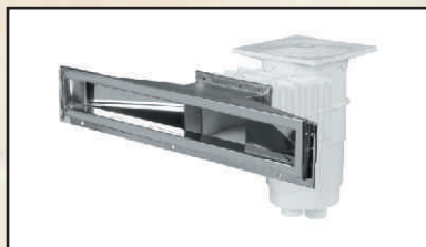
skimmer wąski szer. 80 cm ramka wys. 75 mm stal 316 kod 70014
